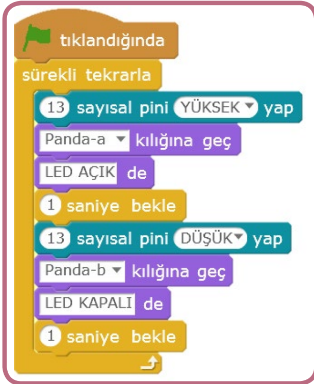
Şekil 137: İnteraktif mod led aç kapa uygulaması
