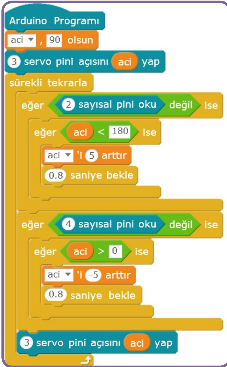
Şekil 155: Servo motor kontrolü uygulama kodları
