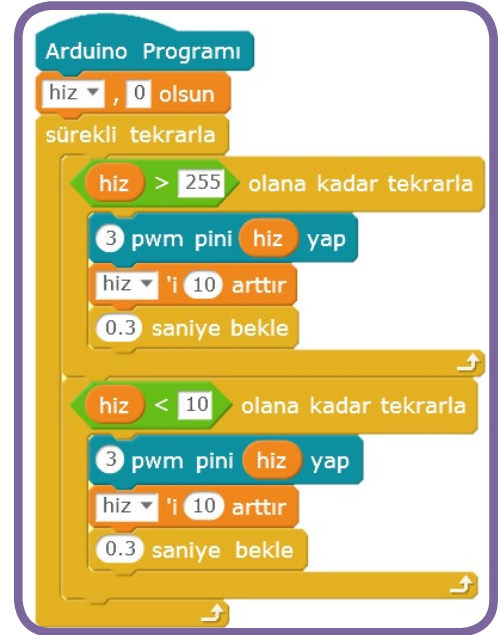
Şekil 148: Motor hız kontrol devresi kodları
